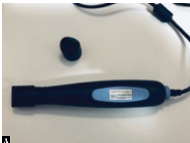
Ryc. 1. Ultrasonografy wysokiej częstotliwości. A. DermaView z głowicą mechaniczną 48 MHz ; B. Episcan z głowicą mechaniczną 50 MHz
